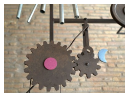
Engrenage de percussion du carillon et de révélation de la lune
